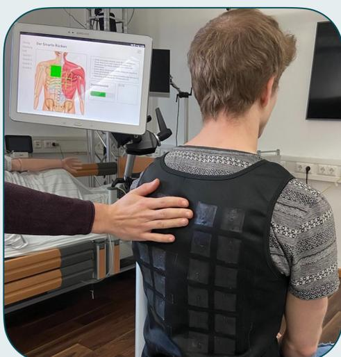
Abb. 1: Weste erkennt Handposition und Druck. Feedback wird in einem GUI dargestellt.
